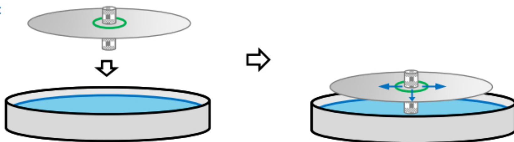
**Beobachtung:** Das Wasser wird durch den Docht angesaugt und fließt von der Mitte aus zum Rand des Filterpapiers. Dabei wird der Farbstoff teilweise mitgerissen. Am Ende des Versuchs ist deutlich eine gelbe Farbstofffront weit außen auf dem Filterpapier zu erkennen und eine blaue Farbstofffront weiter mittig.
